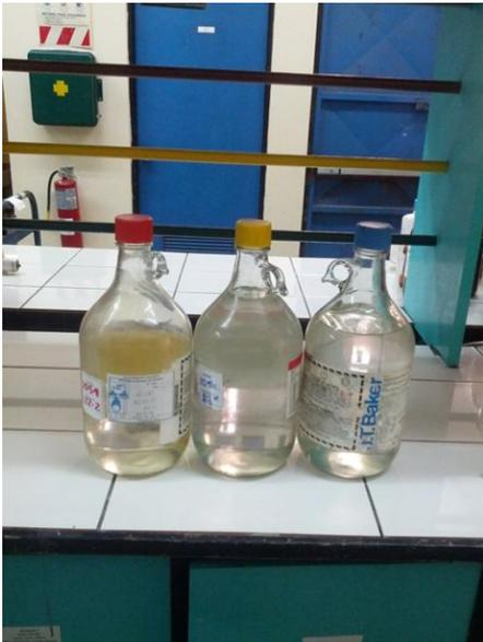
Figura 3. Colores de las tapas de los envases de los ácidos nítrico, sulfúrico y clorhídrico.
